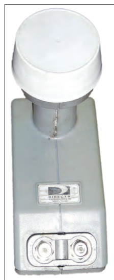
图4 双同轴连接器配置 LNB。用假负载终止一个连接器。
