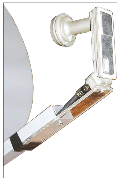
图 3 自制的塑料单 LNB 安装支架
